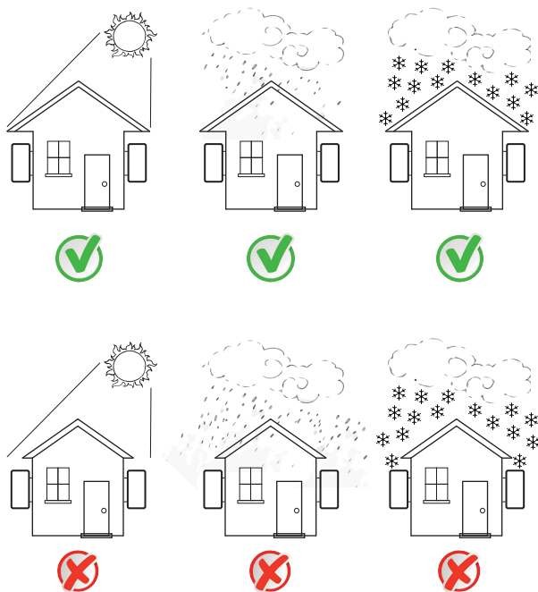
Rys. 4.1 Zalecane miejsce montażu
