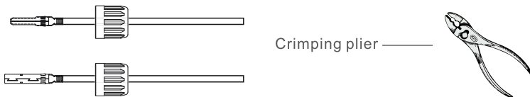
Rys. 5.4 Zacisnąć styk kontaktu na przewodzie
